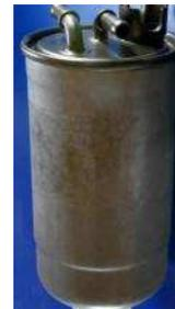
**Mögliche Probleme:** Bei einem Kunden zeigte die Montage im Treibstofffilter keine Wirkung, da der Stift an einer Stelle lag, wo er keinen Kontakt mit dem Treibstoff hatte. Manche Filter haben eine Patrone eingebaut und haben dann keinen Platz für den Stift.
